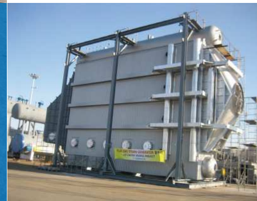
GS칼텍스 VGOFCC 프로젝트 폐열회수 보일러 조립, 운송, 설치 과정
